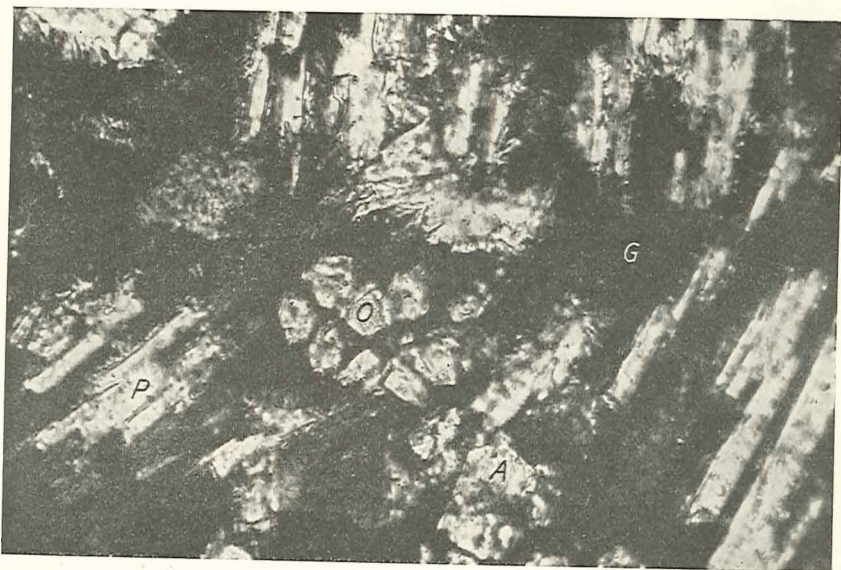
Fig. 8. Finkornet basalt (K. U. 2. 57. 5.), Qutdligssat, Vestgrønland. || Nic. \times 350 . O = olivin; A = augit; P = plagioklas; G = glas. Fine grained basalt, Qutdligssat, West Greenland. O = olivine; A = augite; P = plagioclase; G = glass.
